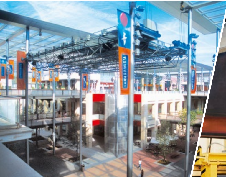
Synchron laufende Hubwerke DH bewegen ein Dachsegment in einem Einkaufszentrum
