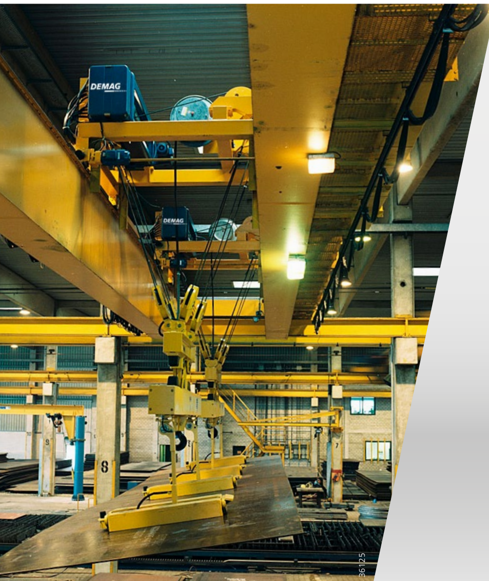
Koaxial gekoppeltes Hubwerk mit Winkelgetriebe, Typ GW
