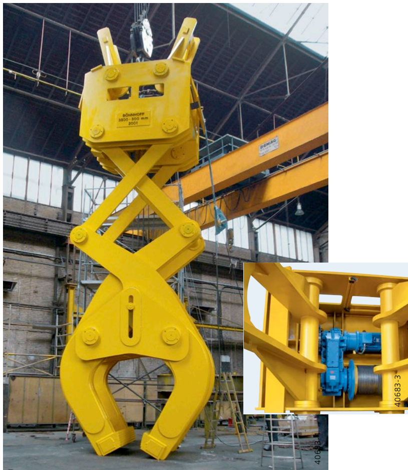
MPW-Windwerk in einem Greifersystem für den Transport von Stahlbrammen
