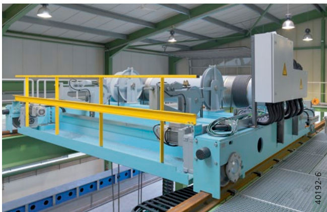
Komplett vormontierte MPW-Katze mit Teleskopgreifer für das Handling von Werkzeugen
