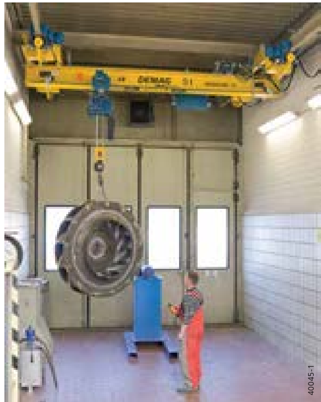
Kleinstmögliche Kettenzug-Katzenfahrmaße dank Deckenkranfahwerk auf Basis von DC-Kettenzugfahrwerken
