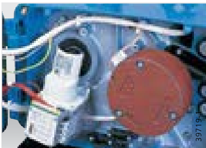
Getriebegrenzschalter GGS mit bis zu 8 Kontakten zur Abschaltung an voreingestellten Positionen
