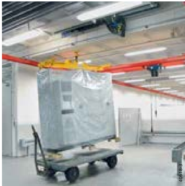
Kurze Katze KLDC mit verlängertem Hakenablauf (BigBag Katze)
