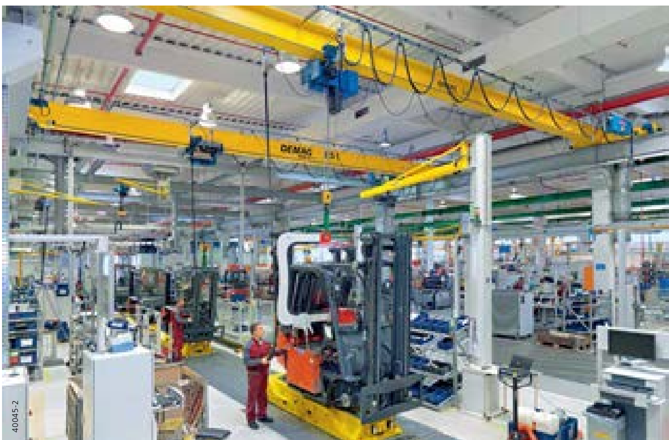
Montagelinie für Gabelstapler: Krantyp EPKE mit Kettenzug DC
