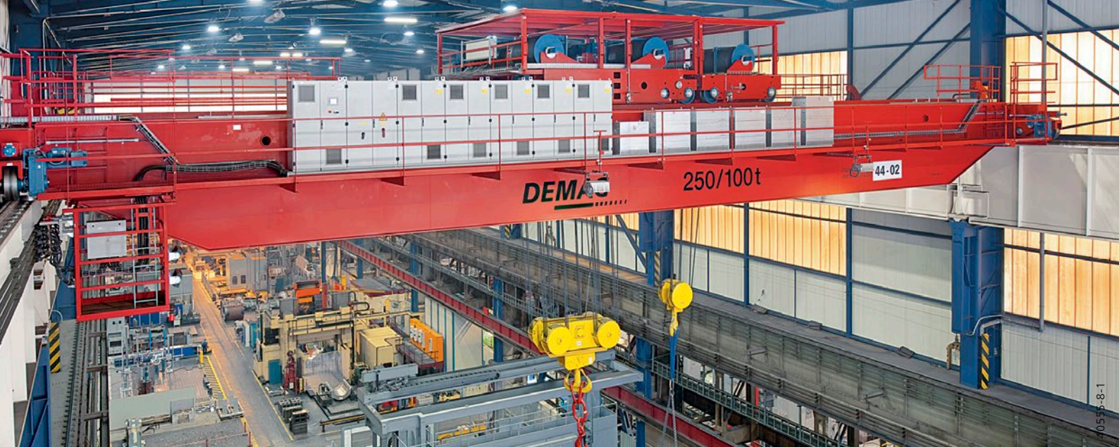
Prozesskran mit einem MPW-Doppel-Hubwerk 250 t auf einer Katze und einem 100-t-MPW-Windwerk
