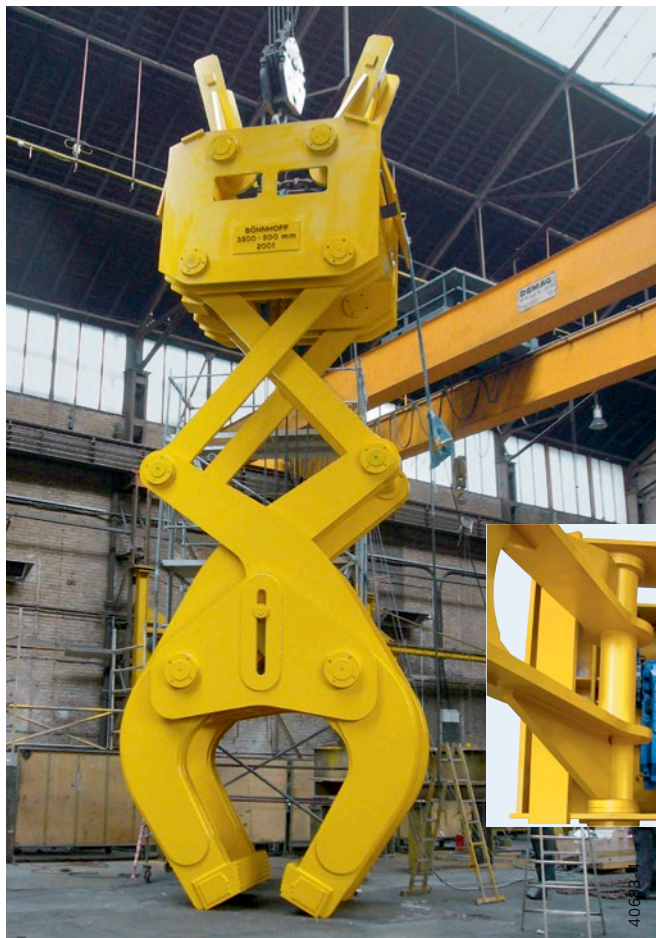
MPW-Windwerk in einem Greifersystem für den Transport von Stahlbrammen
