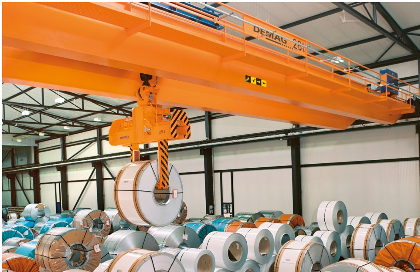
Feinfühlinger Transport von Bandstahl in einem Coil-Lager
