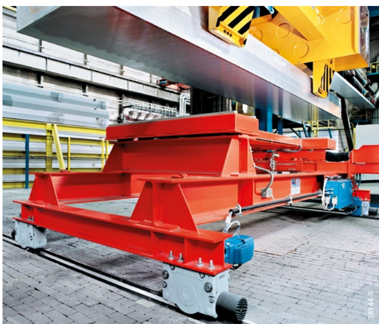
Vierradwagen mit Zentralumrichter zum ruckfreien Verfahren von Aluminiumblöcken
