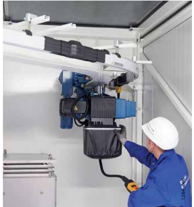
Kurvenkatze: kurze Bauhöhe mit stufenloser Geschwindigkeit
