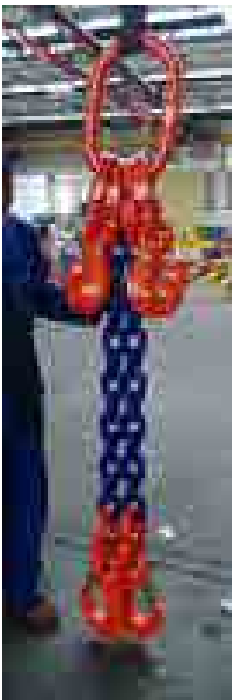
Voorbeeld kettingsamenstel polyester 2- sprong met ooghaken met veiligheidsklep.
